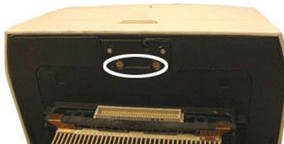
**Рис. 111. Открутите две гайки, чтобы разблокировать оптический модуль.**
