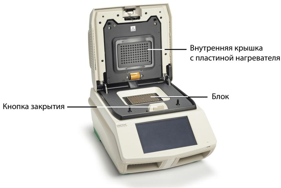
**Рис. 2. Вид Система CFX96 Touch изнутри.**
