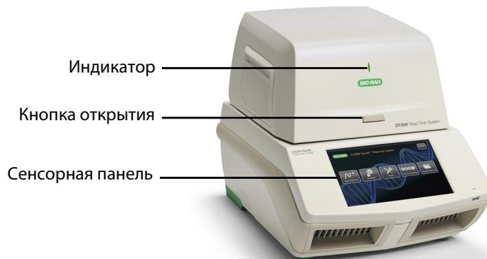
**Рис. 1. Вид системы CFX96 Touch спереди.**
