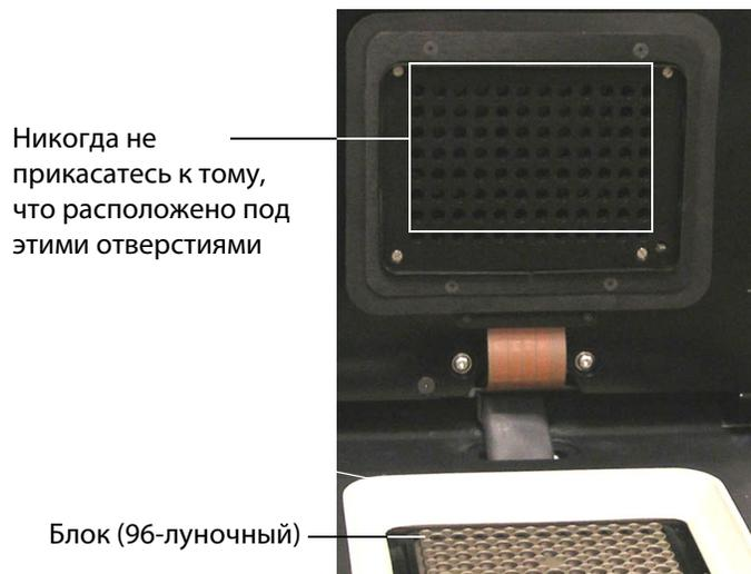
**Рис. 106. Отверстия пластины нагревателя внутренней крышки.**
